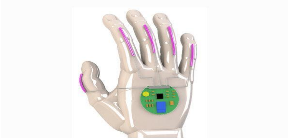
شكل رقم (٥) يوضح القفازات المزودة بأجهزة استشعار
