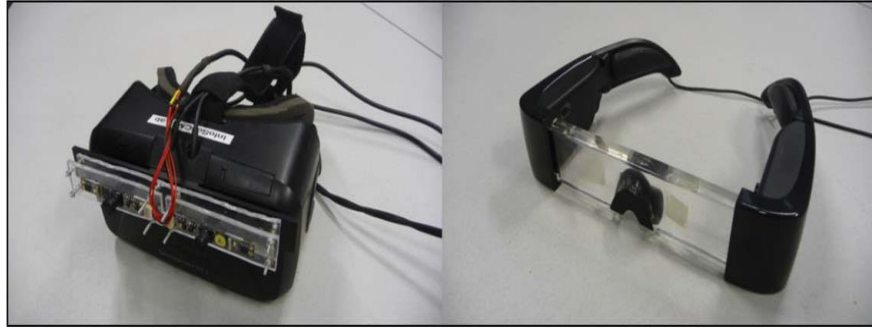
الشكل رقم (1) يوضح نوعان مختلفان من نظام HMD للشفافية: الفيديو للشفافية (اليسار) والاطلاع البصري (اليمين).
